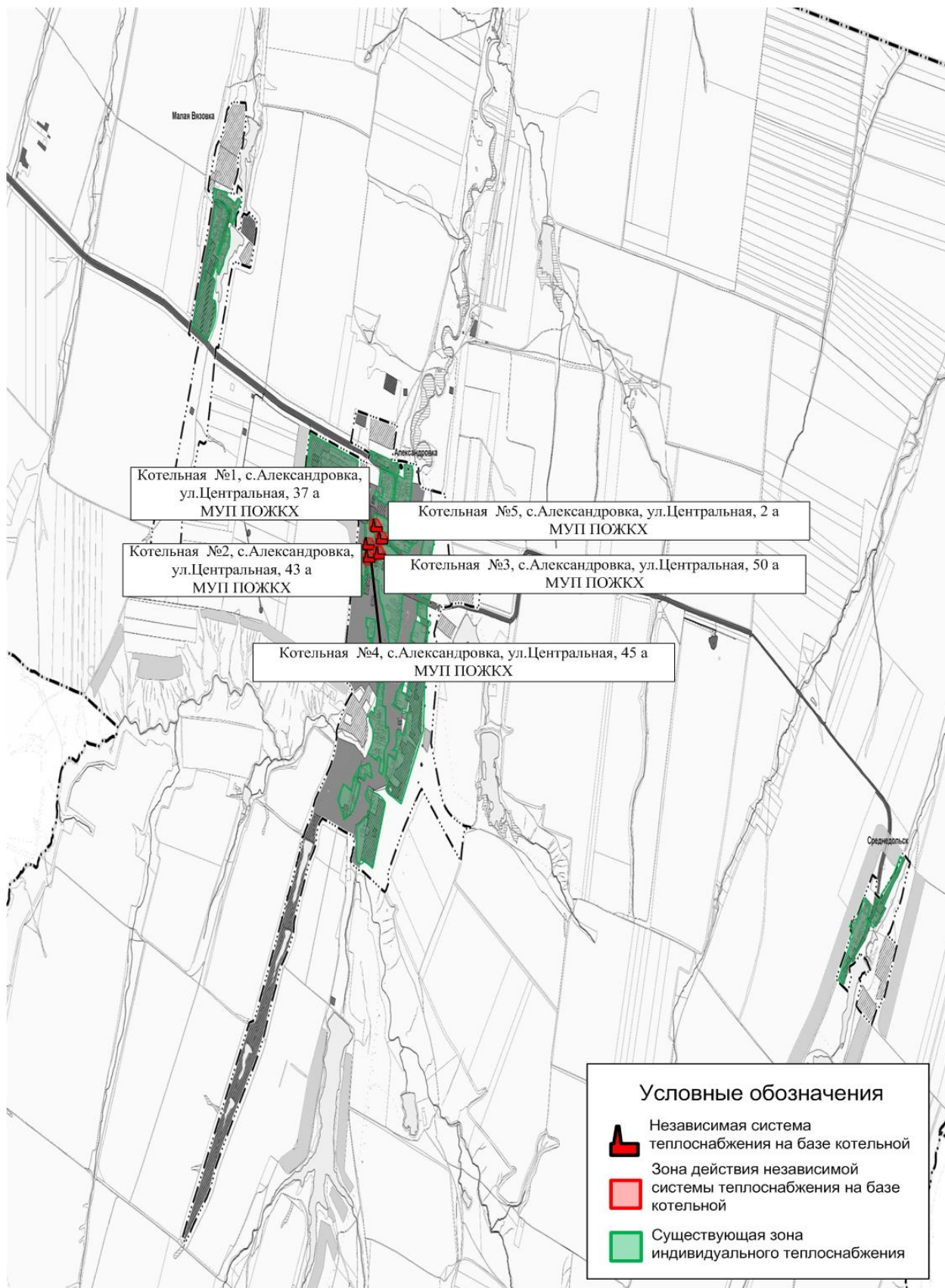
Рис. № 1.4.1 - Зоны действия независимых систем теплоснабжения на базе локальных котельных на территории сельского поселения Александровка
